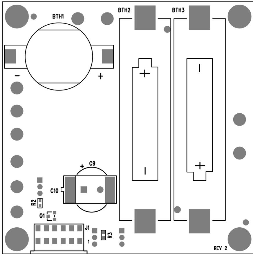
1. ENSURE HEADER KEY FOR J1 IS INSTALLED AND LOCATED AS SHOWN BELOW:
