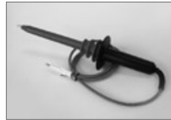
A190702 : 40kV HV Test Probe
