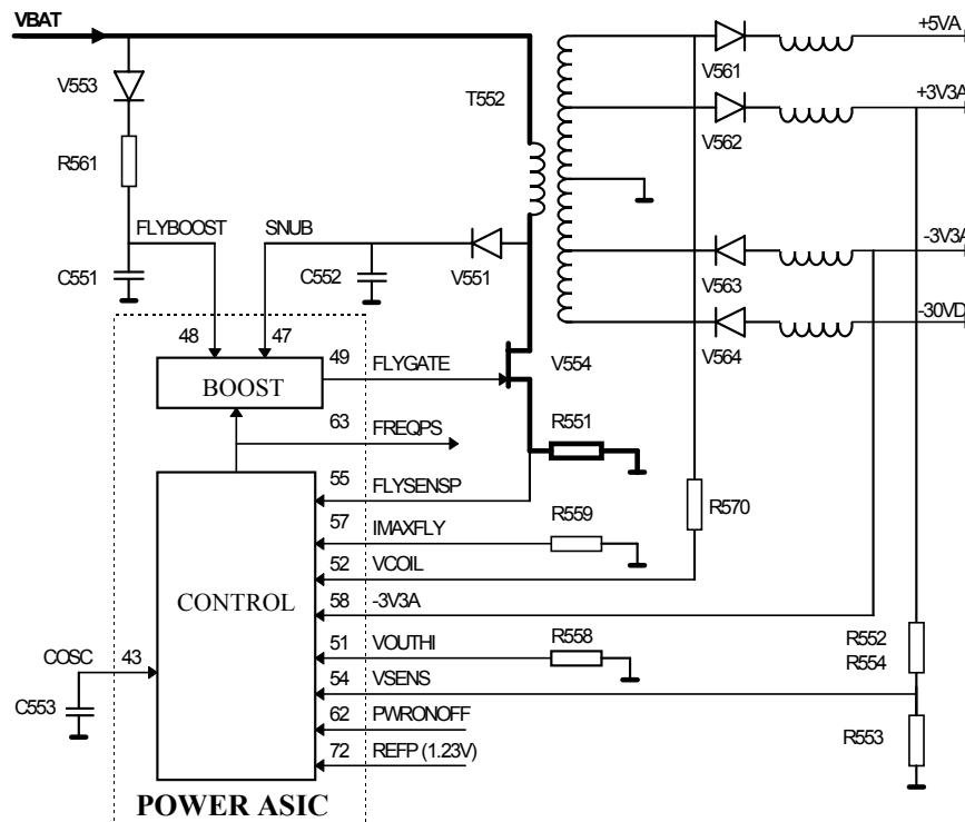
**Figure 3-6. Fly-Back Converter Block Diagram**
