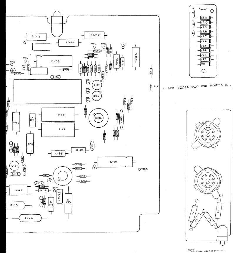
FIGURE 8-6. PRE AMPLIFIER ASSEMBLY COM-PONENT LOCATIONS
