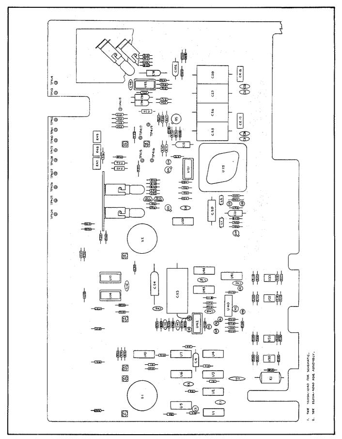
Figure 4-7. LOGIC PCB TEST POINT LOCATION
