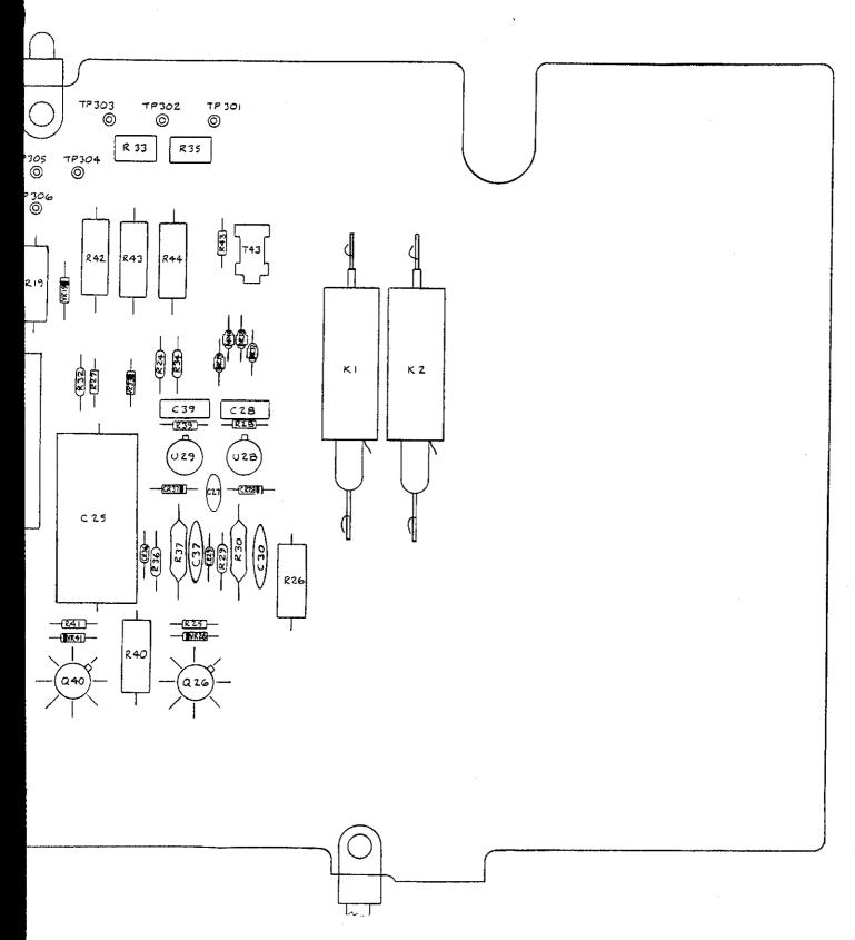
FIGURE 8-8. POWER AMP UPPER TUBE ASSEMBLY COMPONENT LOCATION
