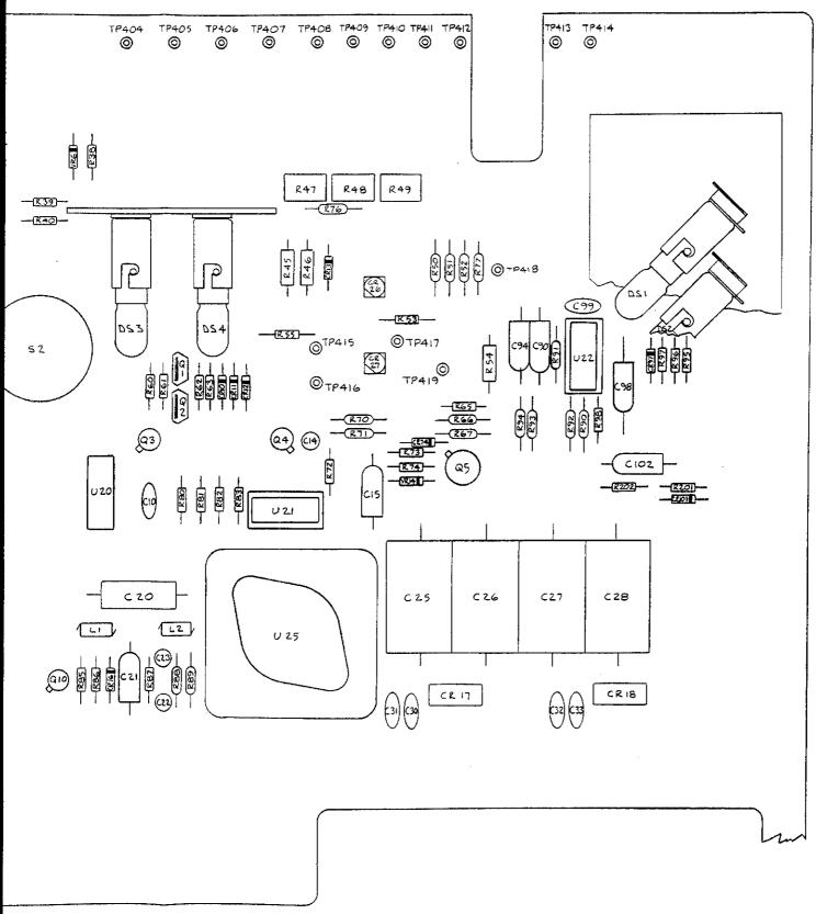
FIGURE 8-4. LOGIC ASSEMBLY COMPONENT LOCATION
