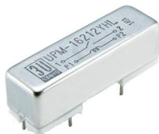
本シリーズは、各導体間絶縁耐圧3000VDC（接点間2500VDC）を保証するために開発された製品です。最大接点容量100Wは、リードリレーの中では最大級に位置し、最大開閉電圧および最大開閉電流は、水銀に匹敵する特性を備えています。
