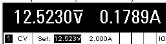
Mode de fonctionnement (CV = mode tension constante)
