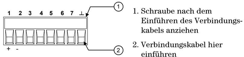
1. Schraube nach dem Einführen des Verbindungskabels anziehen
