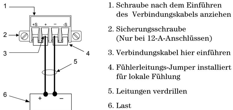
Wenn Sie mehrere Lasten an einen Ausgang anschließen, verwenden Sie separate Kabel zu deren Anschluss an die Ausgangsanschlüsse. Jedes Kabelpaar sollte so kurz wie möglich und verdreht oder gebündelt sein, um Induktionsspannung im Kabel und Rauschaufnahme zu verringern.
