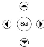
Dem oben angezeigten Menüpfad können Sie entnehmen, dass die in der zweiten Zeile aufgeführten Befehle der Befehlskategorie **Protect** zugehören (sich also auf der Ebene unter **Protect** befinden). Der Befehl **OVP** ist hervorgehoben. Die dritte Zeile zeigt an, welche Funktionen in der Befehlskategorie **OVP** verfügbar sind. Wählen Sie **OVP**, indem Sie die Taste **Sel** drücken.
