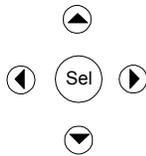
Sie sind nun innerhalb der Befehlsmenüstruktur auf der Ebene zur Steuerung der Funktionen angelangt. Dies ist die unterste Ebene der Menüstruktur. Markieren Sie mit den Navigationstasten den Wert für **OVP Level** (siehe nachfolgende Abbildung). Geben Sie über die numerische Tastatur den gewünschten Überspannungspegel ein. Drücken Sie abschließend **Enter**.
