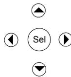
Drücken Sie die Navigationstaste **►**, um zum Befehl **Protect** (Schützen) zu gelangen. Wählen Sie **Protect**, indem Sie die Taste **Sel** drücken.
