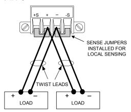
これにより、相互カップリング効果が最小限に抑えられるため、電源システムの低出力インピーダンスをフル活用できます。 負荷インダクタンスとノイズの混入を小さくするため、それぞれのワイヤ対はできるだけ短くし、撚り合わせるか束ねてください。
