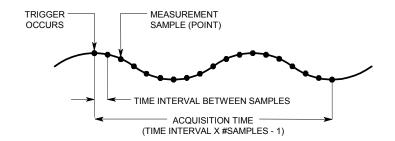
リップル除去は、捕捉ウィンドウに含まれているリップル周波数のサイクル数の関数です。 捕捉ウィンドウのサイクル数が多いほど、リップル除去に優れています。 以下のコマンドを使って、測定データのサンプリング・レートを変更することができます。
