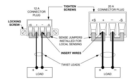
ワイヤをしっかりと接続したら、コネクタ・プラグを本器背面に挿入します。 止めねじを締めて、標準コネクタを固定します。 AC入力コネクタの隣にシャーシ・グランド・バインディング・ポストが用意されています。
