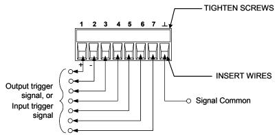
デジタル制御コネクタには、AWG  $14\sim$ AWG 30の線径のワイヤを接続できます。AWG 24より細いワイヤは使用しないでください。 ワイヤを接続するために、コネクタ・プラグを外します。
