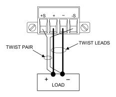
センス・リードは数ミリアンペアの電流しか流さないので、負荷リードより軽量でも問題はありません。 ただし、センス・リードの電圧降下によって、本器の電圧レギュレーションが低下する可能性があります。 センス・リード抵抗を負荷当たり約 $0.5~\Omega$ 未満に抑えるようにしてください。
