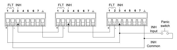
図のように、数台のメインフレームのフォールと出力と禁止入力がデイジー・チェインされている場合は、1台のメインフレームの内部フォールト条件によって、すべてのメインフレームがオフにされます。コントローラまたは外部回路の介入はありません。
