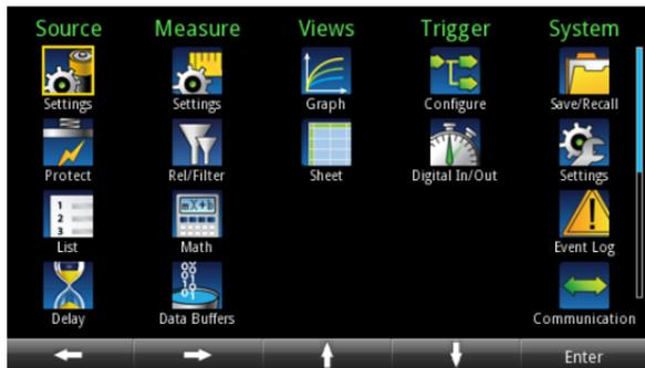
この画面から、ソース、測定、グラフ、トリガ、およびシステム・セットアップ・メニューを選択できます。これらのメニューを使用して、用途に合わせて機器をセットアップするためのオプションを選択できます。セットアップ項目は、ナビゲーション・コントロールをスクロールするか、矢印キーを使用してアイコンを強調表示することにより、選択します。次に **ENTER** キーを押します。
