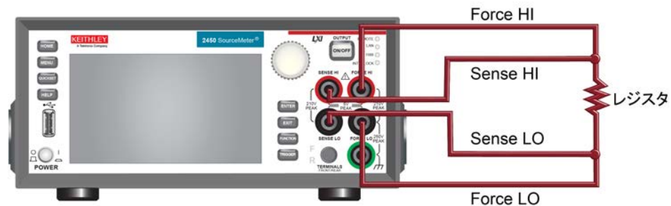
図 19: 低抵抗の測定用のフロント パネル接続
