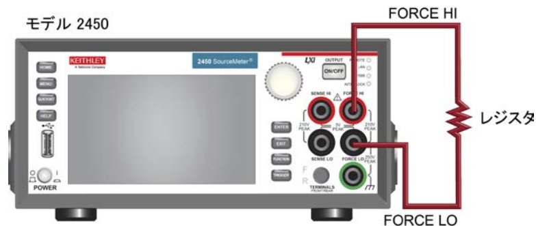
図 17: 2450 型の 2 線フロント パネル接続
