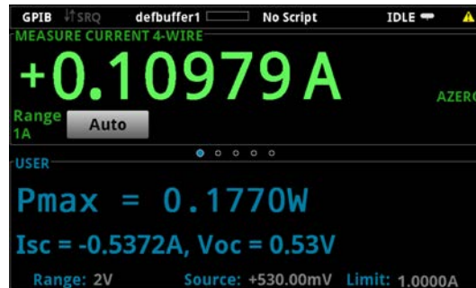
図 48: 太陽電池 I-V 掃引の結果が表示されている USER スワイプ画面
