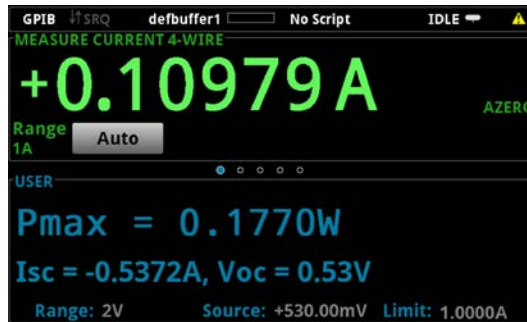
图 48：USER 滑动屏上的太阳能电池 I-V 扫描结果
