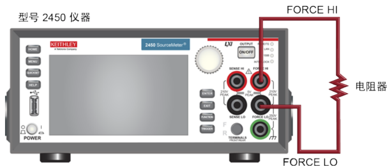
图 17：Model 2450 2 线前面板连接
