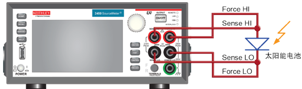
图 45: 到 Model 2450 前面板的 4 线连接
