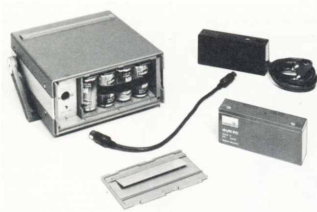
BILD 3 Anstelle der vier Monozellen ist auch ein Akku oder das Netzteil an der Rückseite des HF-Millivoltmeters URV 3 einsetzbar. Foto 26 756
