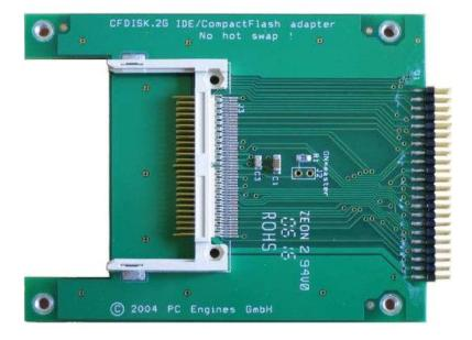
Nun den CF-zu-IDE Adapter wieder mittels des USB-auf-DIE Interfaces per USB an den Windows-Rechner anschließen. Hier zunächst unter Windows die CF-Karte mit NTFS formatieren. Da meine R&S HDD den Namen ROHDE hatte, habe ich diesen Namen auch an die CF-Karte vergeben.
