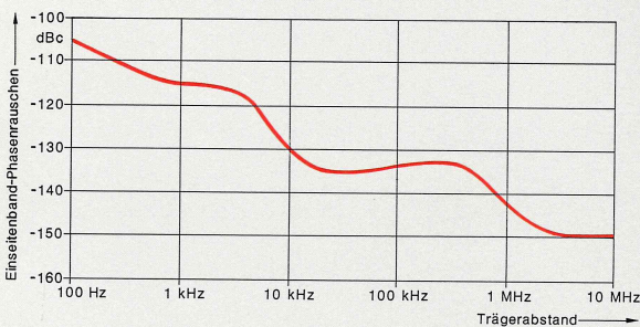
Typisches Einseitenband-Phasenrauschen bei 1000 MHz
