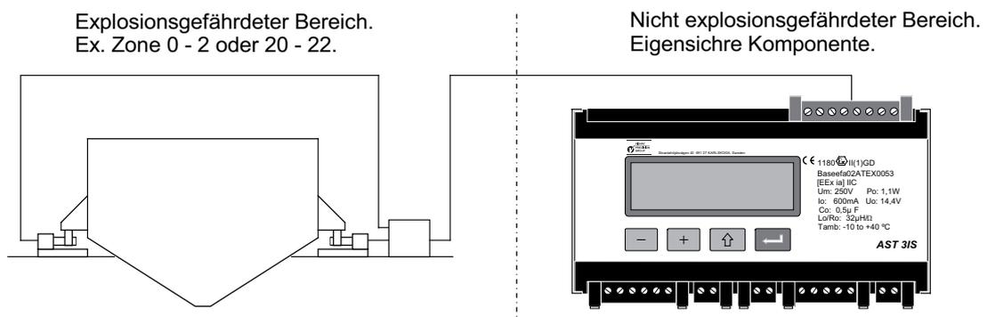
Abbildung 1: Direkter Anschluss des AST 3IS und Waagezellen, im explosionsgefährdetem Bereich.
