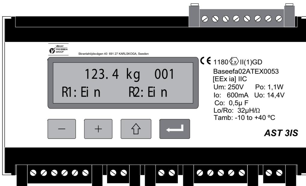
Abbildung 2. Vorderansicht des AST 3IS im Betriebsmodus.
