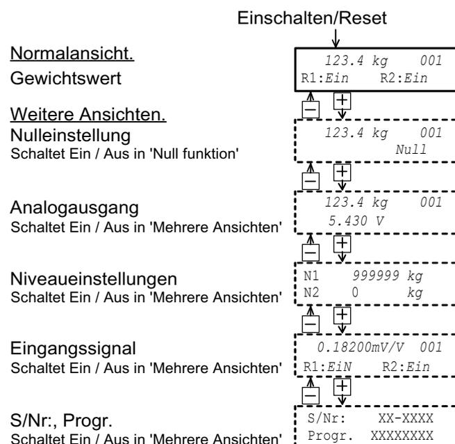
Abbildung 3. Im Betriebsmodus kann der Gewichtswert immer angezeigt werden. Über die Funktionstasten + und - können auch weitere Ansichten ausgewählt werden, vorausgesetzt dass die Ansichte 'Ein'-geschaltet sind.
