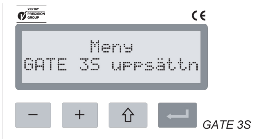
Figur 4. Innan någon parameterändring kan göras måste GATE 3S kopplas om till Uppsättningsläge, och då får panelen detta utseende.
