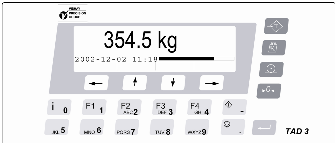
Figur 7 . Frontpanel på viktindikator TAD 3 med LCD-display, fyra funktions-tangenter nedanför displayen, fyra tangenter med vägningssymboler, tolv tangenter med bokstäver och siffror och en RETUR-tangent för att t.ex. avsluta inmatningar.
