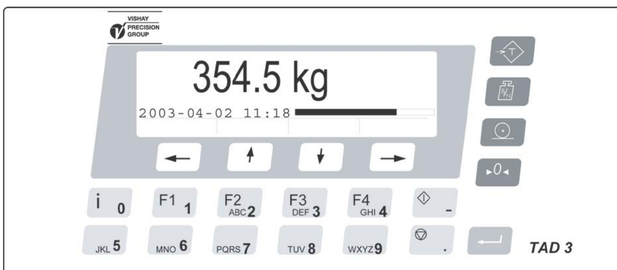
Figur 11. Fronten vid normal vägning med TAD 3 i driftläge.
