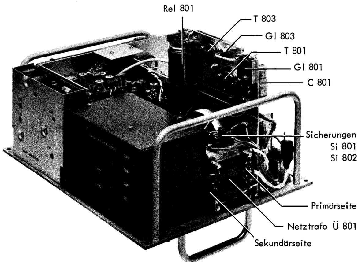
Innenansicht bei hochgeklappter Netz- und Anzeigeschaltung
