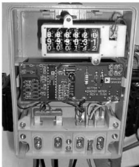
图2 用AD7755设计的电能表实物照片
