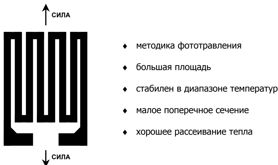
Рис.4.4. Металлофольговый тензодатчик.
