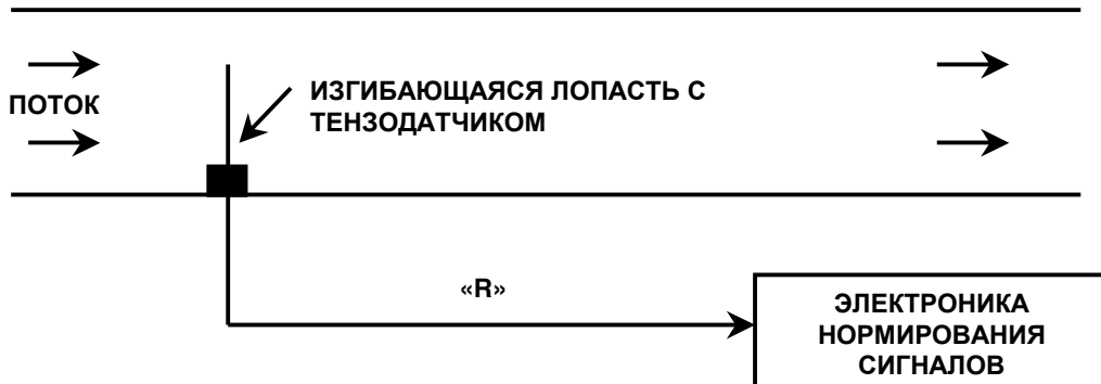
Рис.4.11. Использование сгибающейся лопасти с тензодатчиком для определения скорости потока
