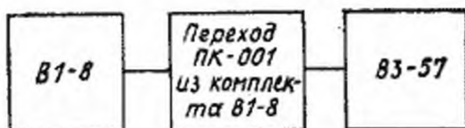
Рис. 7. Схема соединения аппаратуры при определении основной погрешности прибора
