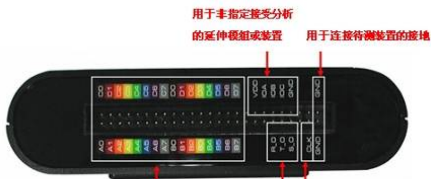
连接埠 A: A0 ~ A7 连接埠 B: B0 ~ B7 连接埠 C: C0 ~ C7 连接埠 D: D0 ~ D7 用于输出信号以 启动其它仪器 用于使用外部时钟连线
