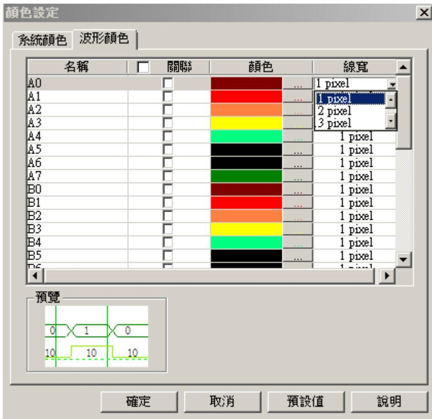
線寬：依使用者習慣選擇線的粗細，預設為 1pixel，波形寬度有 1pixe、2pixe、3pixel 可選擇。
