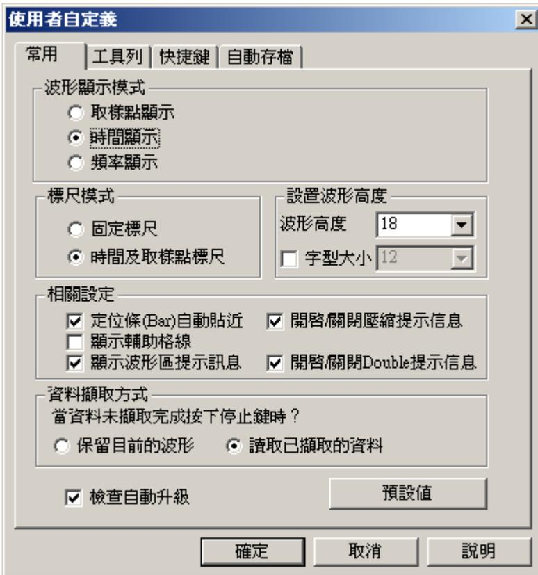
波形顯示模式：需與顯示波形時間<sup>1</sup>功能搭配，顯示波形的訊息
