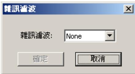
雜訊濾波：原始波形為軟體濾波，可以濾除 0~10 個 Clock 寬度的正脈波或負脈波訊號。當硬體抓到的資料，其波長寬度未超過指定的 clock 數時，軟體將濾除不顯示。只要傳送一次被測物的信號到邏輯分析儀，在雜訊濾波對話框中，選擇需濾波的時脈數值，邏輯分析儀立即切換呈濾波後的資料。如想關閉濾波功能，在雜訊濾波對話框中，選擇 None，螢幕資料會立即切換回原始波形。
