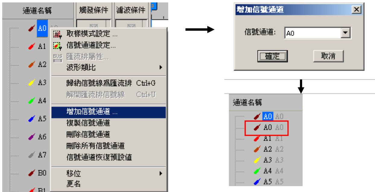
**複製信號通道**：複製選取的通道。在通道中選取所需複製的通道，並按下右鍵，選擇**複製信號通道**，會跳出複製信號通道的視窗，按下確定後，通道名稱區域中會新增剛所選取的通道。
