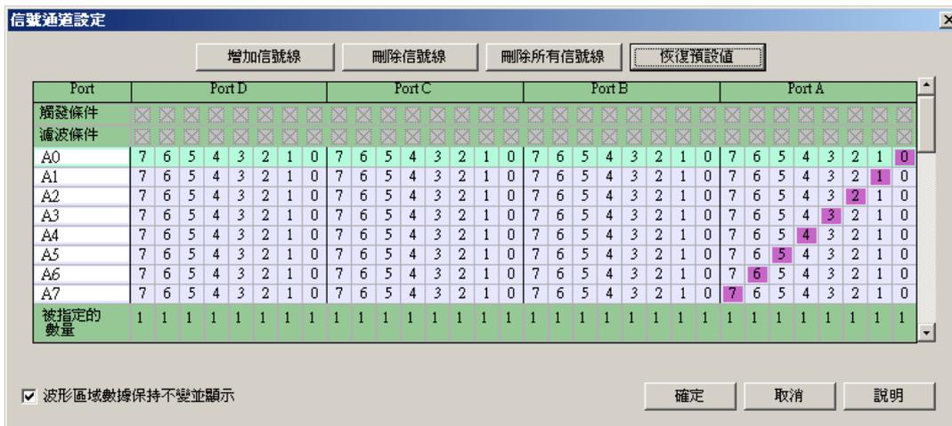
**增加信號線：**增加一個匯流排(Bus)或者一個信號線(Signal)的測試信號。
