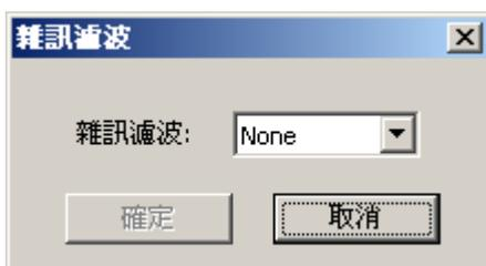
**雜訊濾波**：為軟體濾波，可以濾除 0~10 個 Clock 寬度的正脈波或負脈波訊號。當硬體抓到的資料，其波長寬度未超過指定的 clock 數時，軟體將濾除不顯示。
