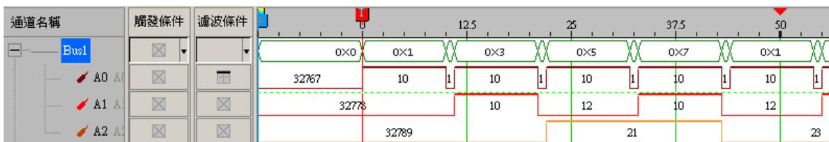
設定信號濾波條件為高準位，並啓用信號濾波間隔時間功能(如下圖)，顯示為有錯誤，因為信號濾波間隔時間功能(要 2 個 clock 以上才支援)，可此波形實際間隔只有 1 個 clock，只記錄到 Display bar flag，未記錄間隔的時間，可是軟體誤以為 Display bar flag 下一個是間隔的時間，實際上為 Data 數據，造成軟體顯示 Display Bar 的間隔時間、所遮著的波形資訊為 5、7、1
