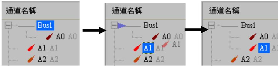
使用鍵盤 Ctrl 與 Shift 並配合按滑鼠左鍵，作連續點選並讓多個信號線(Signal)呈現被選擇的狀態，然後不放滑鼠左鍵並拉動滑鼠進行移動，而在拖移到匯流排(BUS)的後端或前端時再放開滑鼠左鍵，如此即完成將多個信號線加入到匯流排(BUS)的動作。
