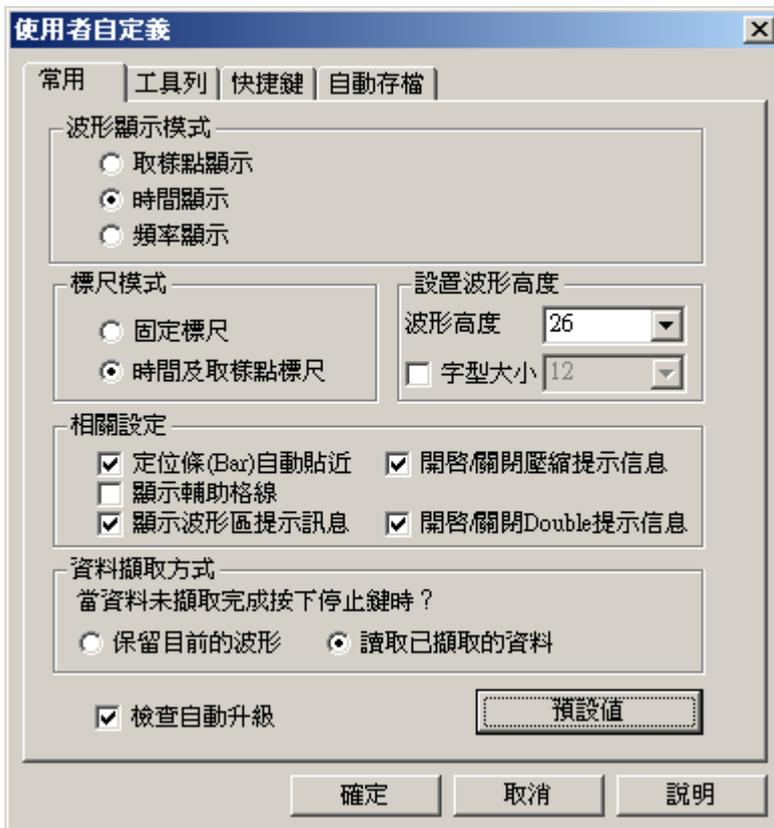
**波形顯示模式：**三種模式選擇，在設定完成後，相對應的“訊息顯示區”顯示方式，則會跟著“取樣點、時間、頻率”作變化；工具列上亦有此三種模式的設定按鈕。
