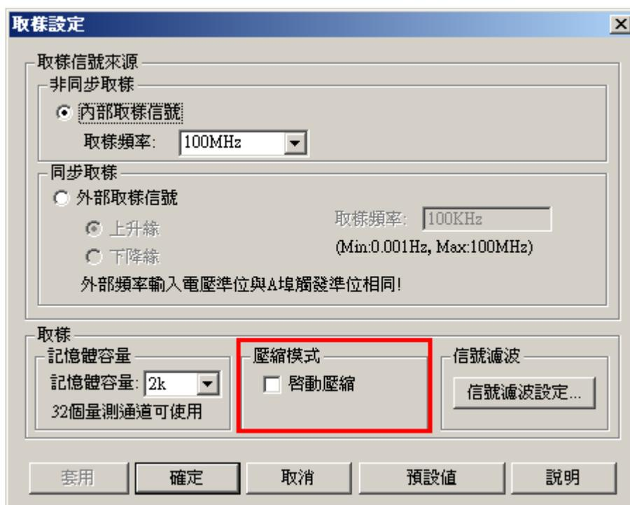
壓縮顧名思義可以瞭解是將被測物的訊號做即時且不損失資料的壓縮，壓縮的目的是將有限的記憶空間透過壓縮的技術得到比實際硬體記憶容量還大的資料，壓縮技術的加入可讓您獲得更多的取樣資料，資料的解析度更高且不失寶貴的記憶空間。邏輯分析儀的壓縮率達 255 倍，也就是當記憶容量選擇在 128K 時，最大可擷取的資料量達  $128K * 255 = 32M$  Bits(Per Channel)、當記憶容量選擇在 1M 時，最大可擷取的資料量達  $1M * 255 = 255M$  Bits(Per Channel)，當然壓縮率會隨著被分析的資料內容而定。
