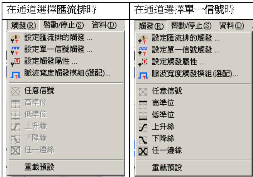
**設定匯流排的觸發：**打開匯流排的觸發(Bus Trigger) 屬性值對話框。
