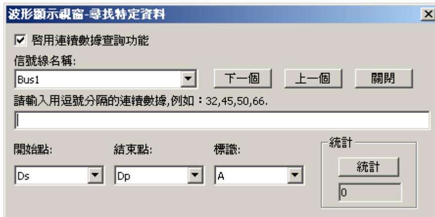
**啓用連續數據查詢功能：**開啓匯流排連續資料的多階查找，開啓此功能，匯流排專案、查找、最小數值、最大數值都不可見。新增輸入連續資料的編輯框，進行多階查找，可輸入匯流排的連續資料，並用逗號分隔，就可進行對這組資料的查找。預設不開啓此功能。
