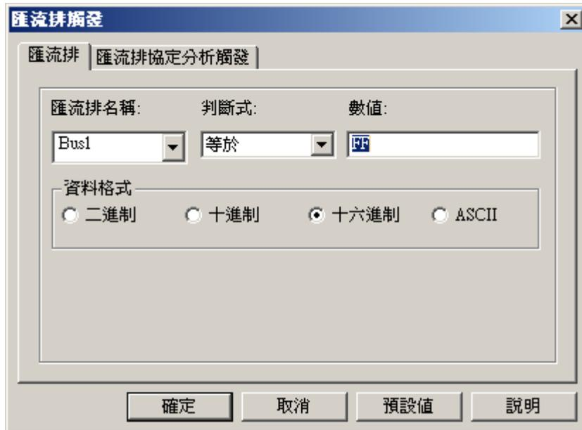
在匯流排名稱欄顯示，已被選擇的匯流排(Bus)名稱；在判斷式欄顯示操作，包括有“任意信號”和‘等於’，當選擇“任意信號”操作時，數值和資料格式項，則會呈現灰色，不能作用；當在判斷式中選擇‘等於’項時，數值和資料格式項都可使用，數值項中的輸入會受到資料格式項中的選擇限制，當輸入的值與資料格式不符合時，會跳出警告訊息視窗，請使用者重新輸入，當輸入的值超過數值模式所設定的範圍時，則會在按下確定鈕後，再跳出錯誤訊息。
