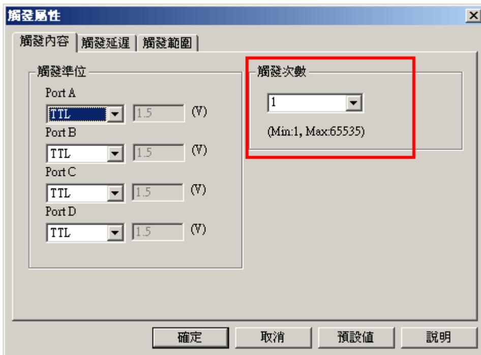
依據觸發位置的設定值，已決定了符合觸發狀態的資料的前與後的顯示長度，這個比例是當觸發位置設定後就成立了，但是我們可以再設定觸發次數來決定觸發點的位置，例如在我們要分析的資料上有一個以上的點符合我們所設定的觸發狀態時，我們就可設定觸發次數來獲得我們需要的資料區段，我們設定觸發次數=1時，就是以第一次符合觸發狀態時的點為**觸發位置**，又我們設定觸發次數=2時，就是以第二次符合觸發狀態時的點為**觸發位置**，第一次的觸發點就跳過了沒有產生觸發，等待邏輯分析儀擷取資料結束後，顯示在波形顯示區觸發點即為第二次符合觸發狀態的點，觸發點的前後資料也是以第二次觸發點為觸發比例(觸發位置)的分界點。
