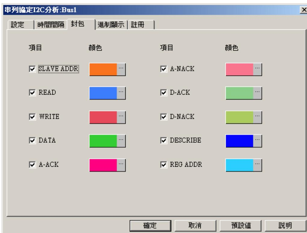
**項目：**選擇需要在封包列表中顯示的內容，包括 ADDRESS，READ，WRITE，DATA，A-ACK，A-NACK，D-ACK，D-NACK，DESCRIBE。
