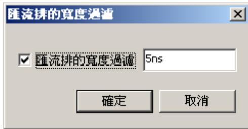
在對話框中勾選啓用匯流排的寬度過濾功能，右邊的編輯框中就可以輸入相應的過濾寬度值。時間及頻率模式下輸入時間寬度值，以時間為單位，如果輸入的值不在範圍內，會轉換範圍內的最佳時間值。取樣點模式下輸入 Clock 寬度，輸入範圍在 1~65535 之間。
