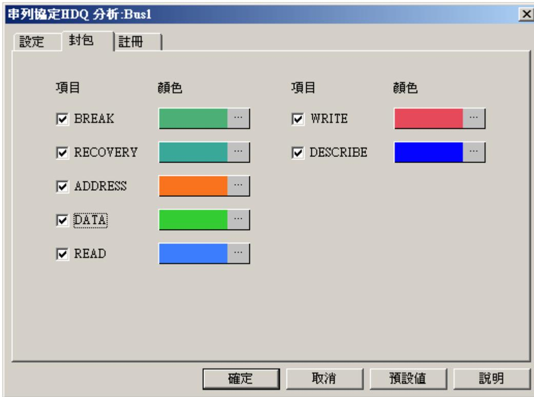
**項目：**選取需要在封包列表中顯示的內容，包括 Break, Recovery, Address, Data, Read, Write, Describe
