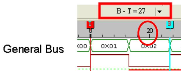
上圖是一個普通匯流排，假設封包的起點為 T BAR，而設定的普通匯流排長度為 20 個位址，但是此時資料 0x02 尚未結束，那麼此封包將會自動延長至此資料的結束點位址為 27(即 B BAR)為封包結束點。
