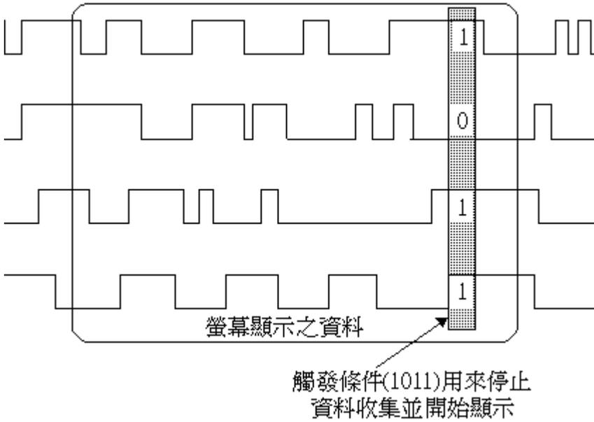
上圖的意義為 Trigger 設定為 A0=1, A1=0, A2=1, A3=1, A0~A3 輸入一連串的被測信號一直到被測物的信號有出現 1011 時，邏輯分析儀就可依據觸發位置的設定值來決定需要再擷取多少資料後結束。
