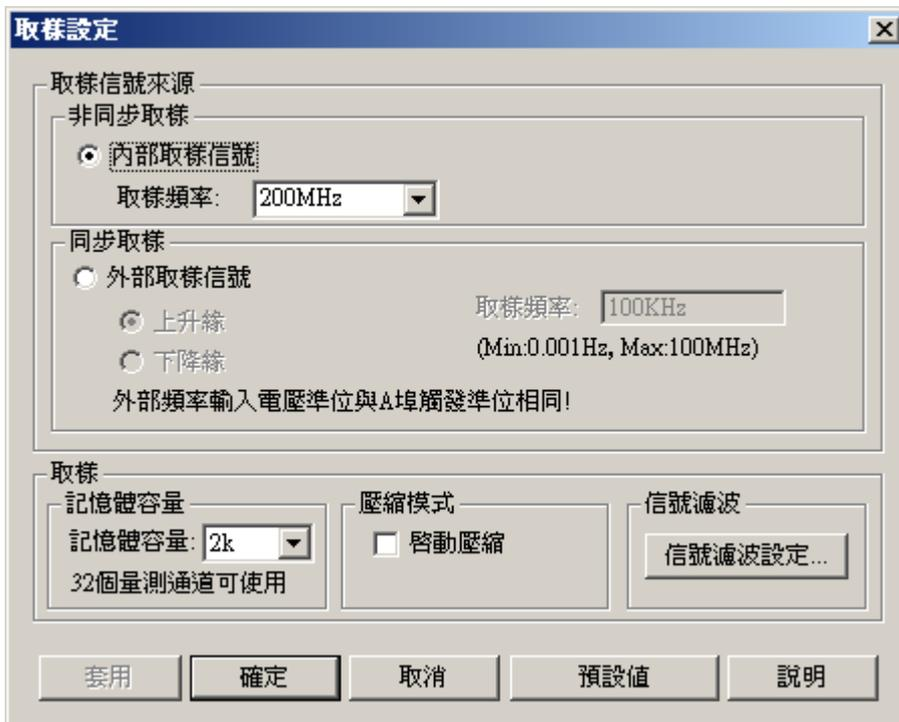
取樣信號的來源共有二個可供選擇《非同步取樣(內部取樣信號)、同步取樣(外部取樣信號)》，點選功能表列上的**信號(U)** -> **取樣模式設定**會出現上圖的對話框，設定方式如下面的說明：
