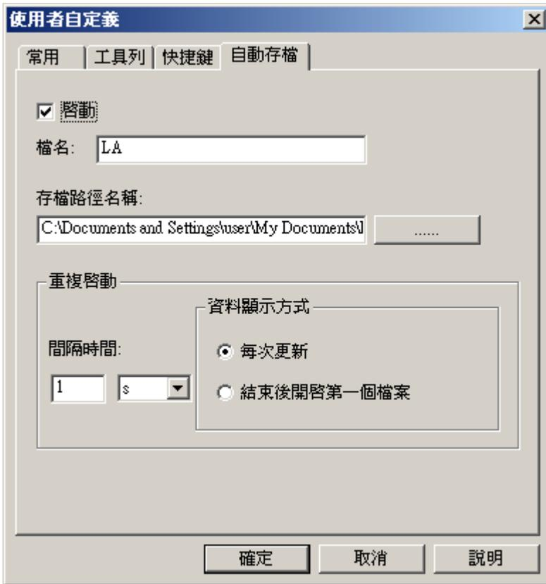
**啟動：**預設為不啟動，啟動後將一直保持為啟動狀態，可選擇關閉。在未啟動的情況下，檔名、存檔路徑名稱、重複擷取間隔時間的編輯框及按鈕皆為無法設定狀態，啟動後才可以設定。
