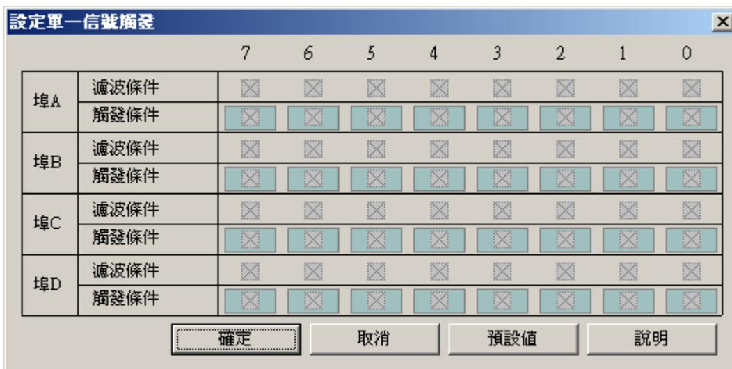
在觸發條件的每個量測通道上用滑鼠左鍵單擊，會依次任意信號(Don't Care)，高準位(High)，低準位(Low)，上升緣(Rising Edge)，下降緣(Falling Edge)，任一邊緣(Either Edge)變化，當所有的觸發條件的量測通道都設定好後就可以按下列按鈕了。
