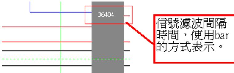
**啓用間隔棒：** 選取核取框表示您已開啓此功能，即可以在畫面中顯示被測信號被刪除的資料長度。
