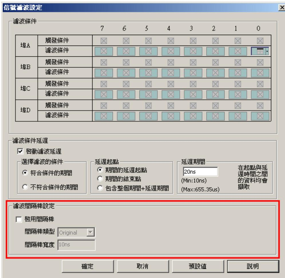
信號濾波間隔時間功能是讓邏輯分析儀只擷取需要的資料，不需要的資料就沒有存到記憶體中！若想要知道被測信號被刪除的資料長度，可以將信號濾波間隔棒功能啓動，這個功能啓動後，可以在畫面中顯
