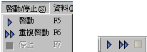
另外利用邏輯分析儀上的 START 按鈕也可啓動邏輯分析儀進行取樣，操作方式與滑鼠去點選
