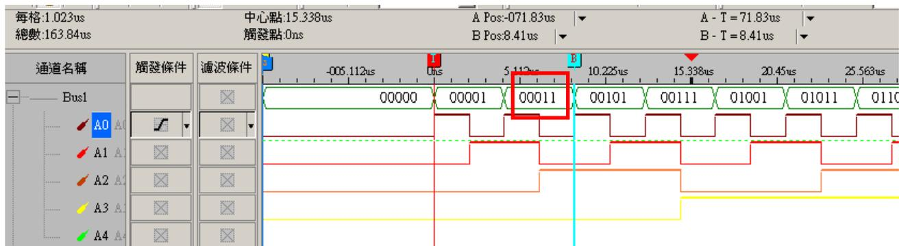
說明：選擇通道爲 A0，分析模式爲 Rising analysis (上升緣)，表示在 A0 通道的上升緣讀取該段資料，如圖中 A Bar 標誌點，此時匯流排通道從下往上的資料依次爲 0011，故該 BUS 資料段 DATA 爲 0011。
