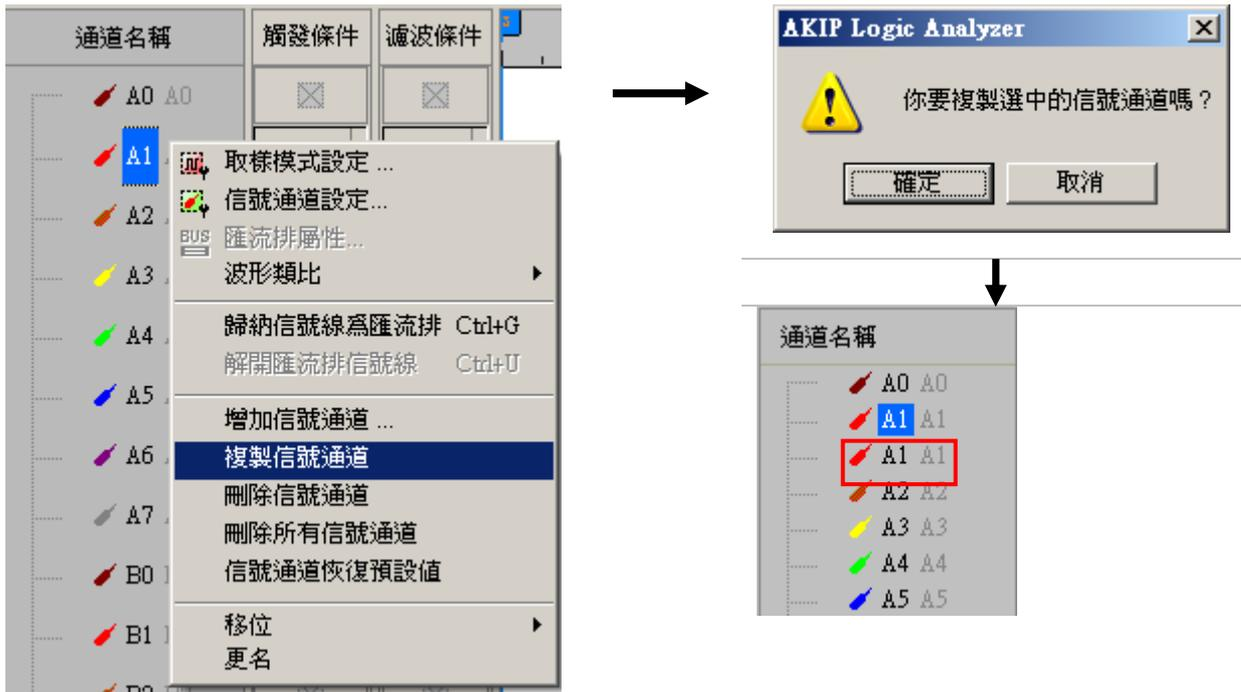
**刪除信號通道：**刪除選取的通道。在通道中選取所需刪除的通道，並按下右鍵，選擇**刪除信號通道**，會跳出刪除信號通道的視窗，按下確定後，通道名稱區域中不會顯示剛選取的通道。
