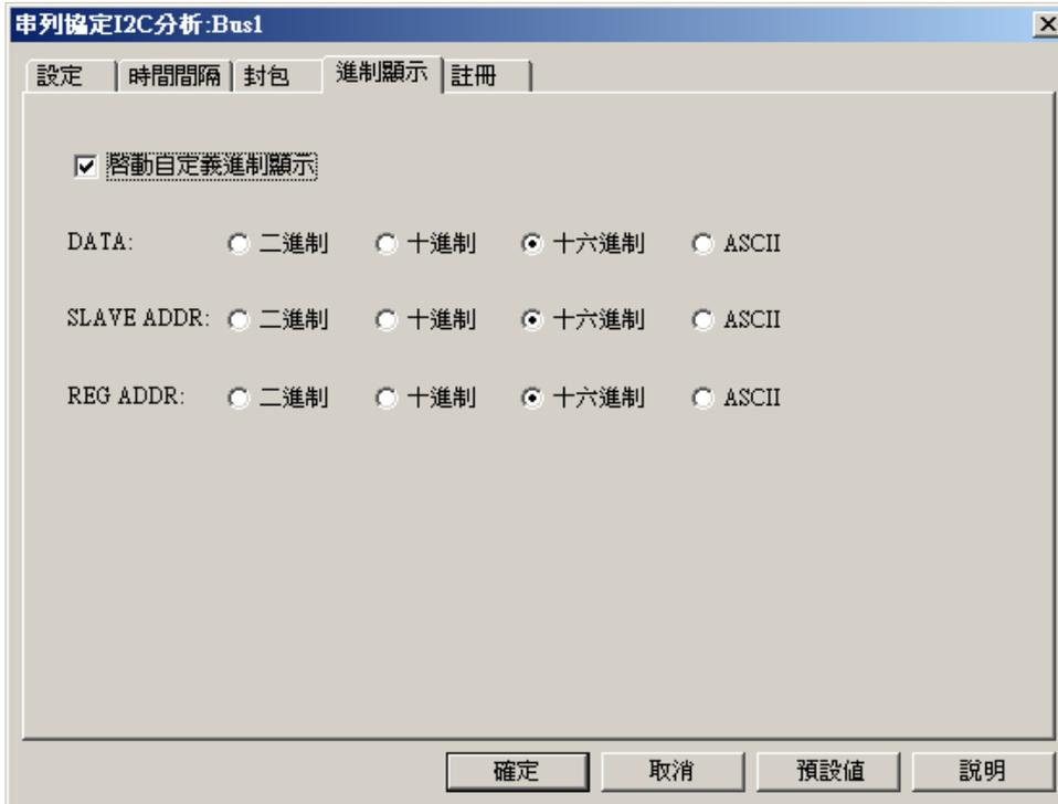
使用者可自定義封包 DATA，SLAVE ADDR,REG ADDR 進制顯示，當啓用時，以模組進制顯示設定為準，不啓用時，以主程序設定資料格式為準。
