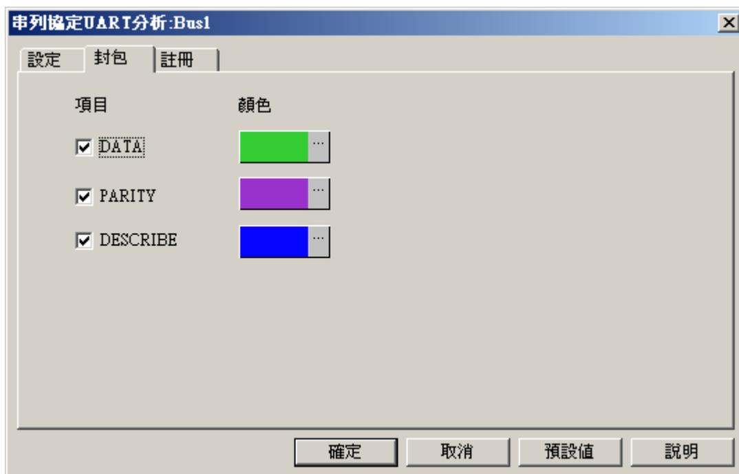
**DATA:** 封包顯示中列出匯流排獲取信號的資料段
