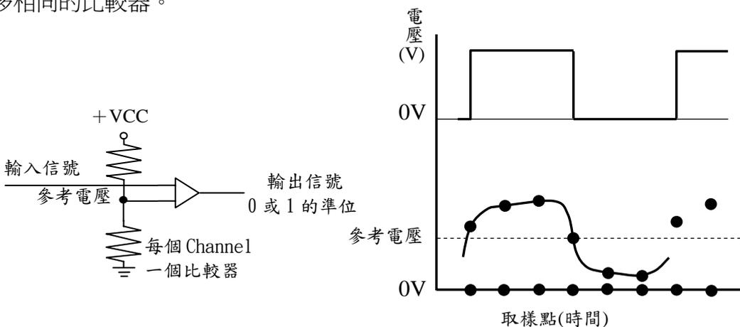
還有，爲了獲取高頻率，相似的信號，一台示波器必須比一台邏輯分析儀以更快的速度取樣。如果在給定相同的儲存空間大小的情況下，一台邏輯分析儀比一台數位示波器就能夠進行更長的時間內進行採集資料。
