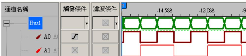
已變更波形的寬度，匯流排 Bus1、通道 A0 波形寬度為 3pixel，通道 A1 波形寬度為 1pixel
