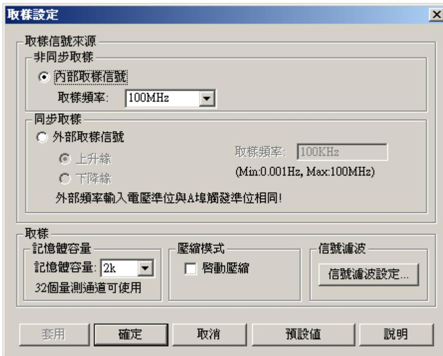
**非同步取樣 - 內部取樣信號：**使用內部時鐘，即邏輯分析儀自己內部設定的固定頻率進行取樣。
