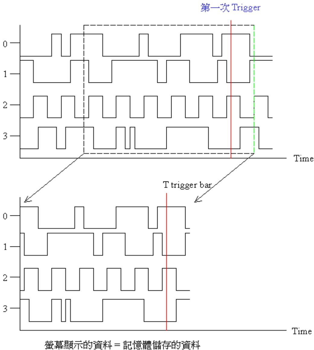
2. 使用觸發次數功能：可以設定要擷取第 n 次觸發(Trigger)發生時的信號。
