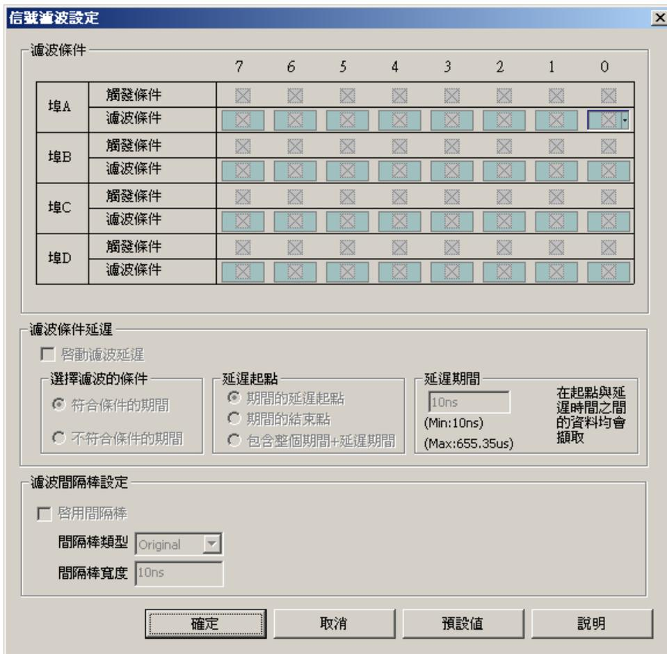
此對話框主要實現對「信號濾波」功能中各項參數的設置並支援顯示信號濾波間隔時間，在信號濾波中的**濾波條件**中的設定，利用滑鼠的左鍵單擊，選擇結果順序依次為 任意信號(Don't Care)，高準位(High)，低準位(Low)；或者單擊滑鼠右鍵，在下拉功能表中選擇濾波的條件。
