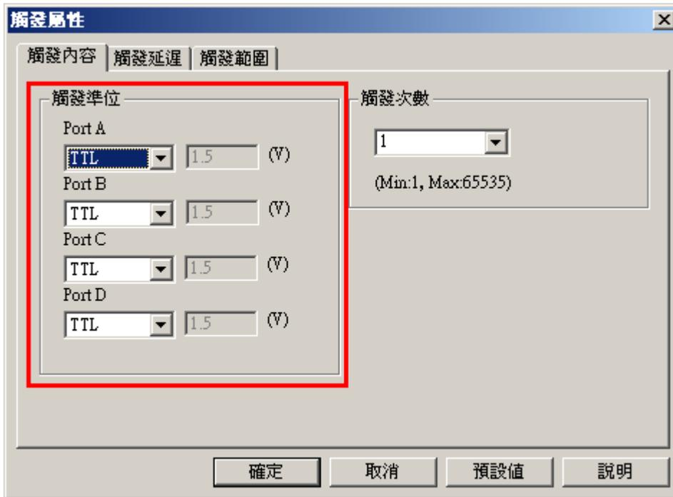
在觸發(R) ->觸發屬性或按下在 Toolbar 的
