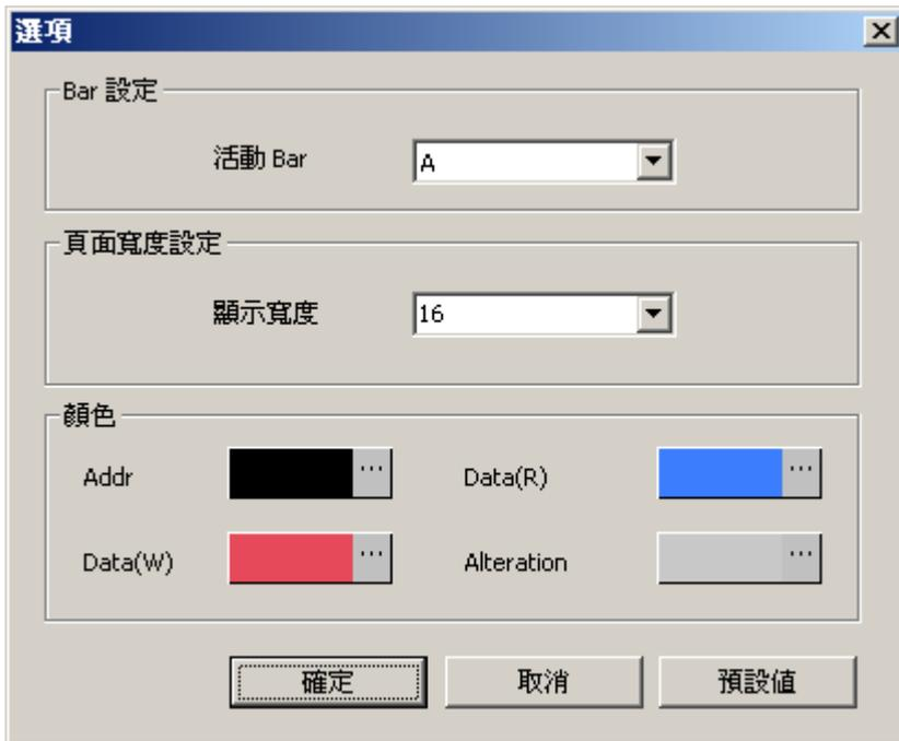
**活動 Bar**：預設值為 A Bar，如果使用者有增加 Bar，所增加的 Bar 也顯示在下拉清單可選擇。Ds/Dp Bar 及 T Bar 不顯示在下拉清單。活動 Bar 所在的封包所有資料及資料位置，將顯示在記憶體分析列表視窗。
