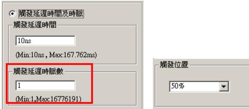
在觸發延遲時脈直接輸入需延遲的 Clock 數值即位址數值後，並配合觸發位置的選擇時；則在觸發後需要延遲的總位元址數值資料長度，其計算方式，為設定遇到觸發點後，輸入位址數值資料長度並加上“觸發位置在總位址數值長度所佔的百分比例”，即為欲顯示的資料總位址數值長度。
