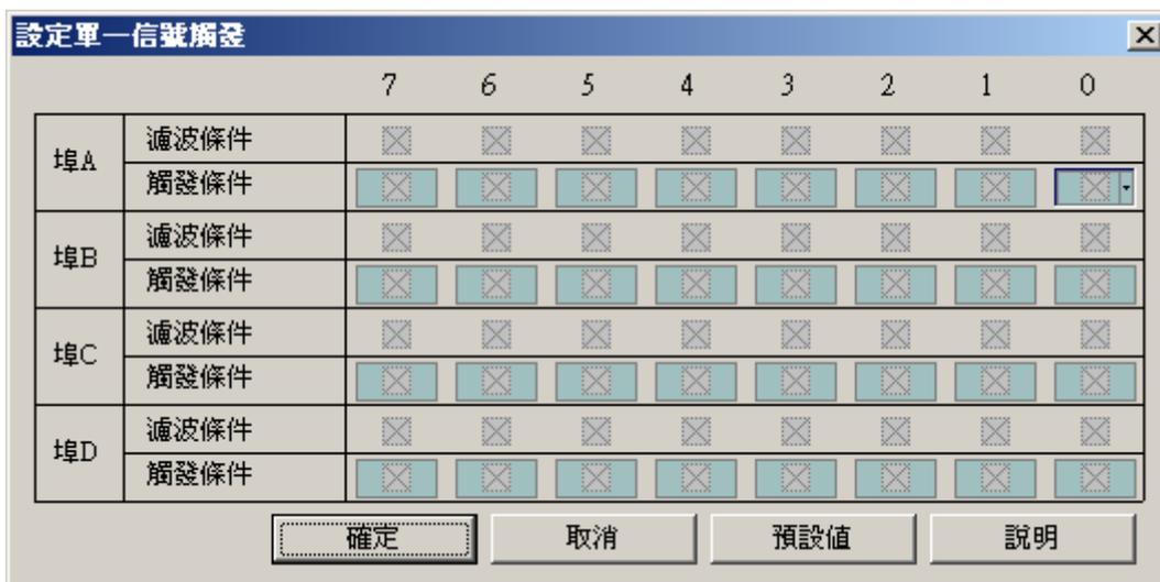
三種方式的設定觸發的條件(上升緣(Rising Edge)、下降緣(Falling Edge)任一邊緣(Rising or Falling Edge (Either Edge))，這三種是相通的，使用任一種的方式來設定，均會對已設定好的三種方式的設定觸發的條件(上升緣(Rising Edge)、下降緣(Falling Edge)任一邊緣(Rising or Falling Edge (Either Edge))，作改變觸發的條件。
