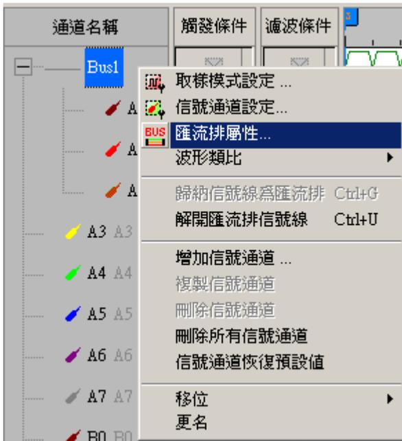
注意：必須信號線歸納為匯流排，有匯流排時，匯流排屬性功能才能使用，如無匯流排時，匯流排屬性功能成反白狀態不能使用
