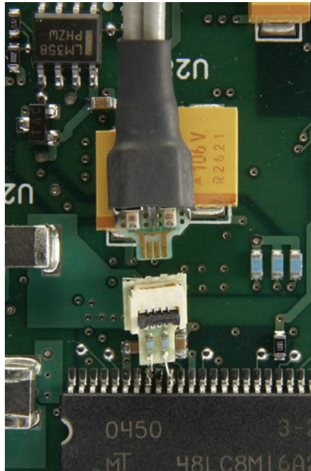
InfiniiMax ZIF tip soldered on board
