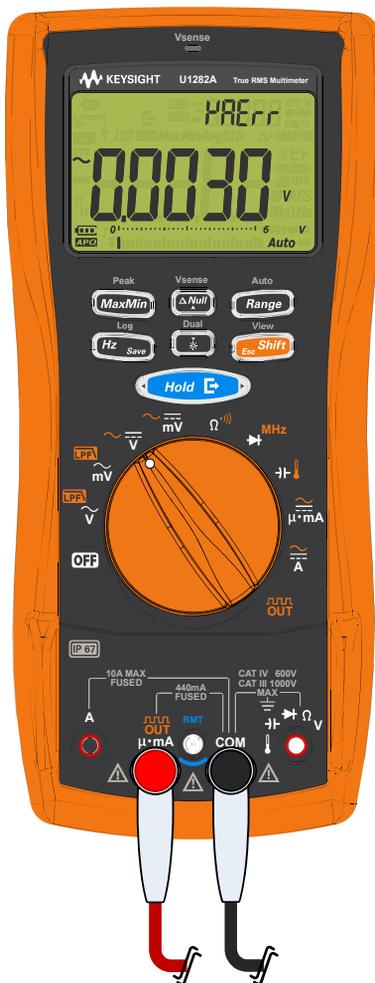
Рис. 1–4 Пример неправильного присоединения входных проводов к разъемам
