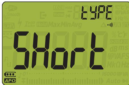
Рис. 4–12 Отображение tYPE – целостность
