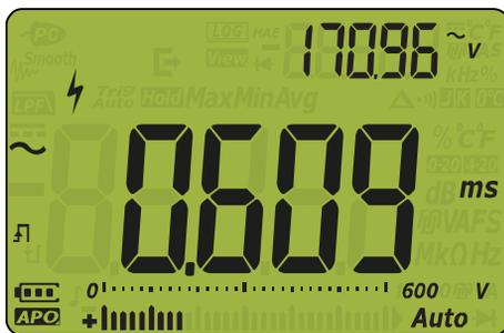
**Рис. 2–33** Отображение длительности импульса
