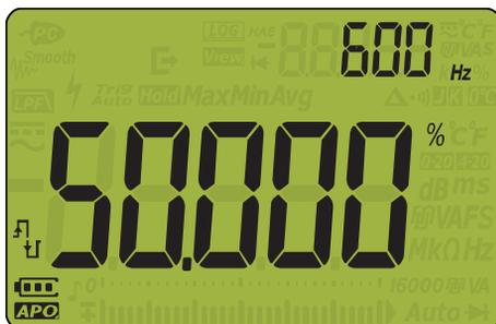
Рис. 2–35 Отображение вывода прямоугольного сигнала
