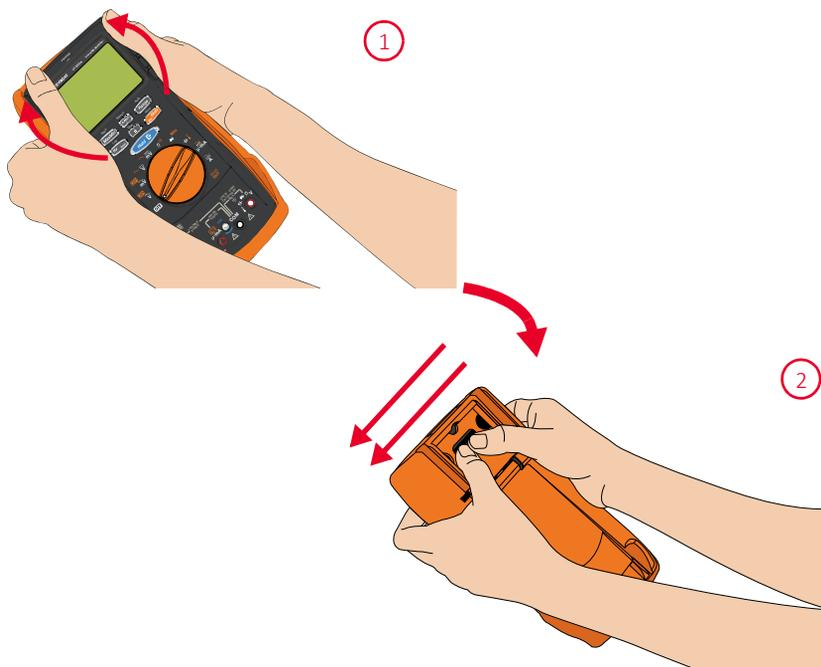
Рис. 1–1 Извлечение мультиметра из оранжевого резинового кожуха
