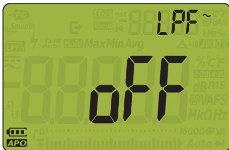
Рис. 4–21 Отображение ФНЧ – переменный ток
