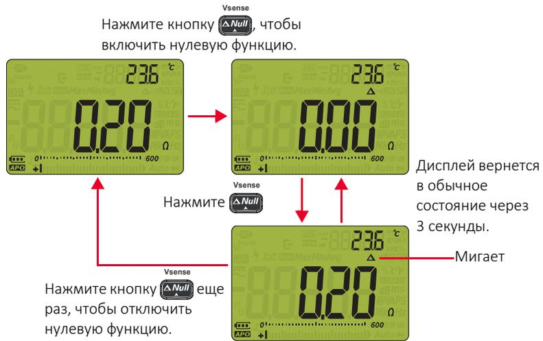
**Рис. 3–3** Принцип работы нулевой функции
