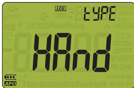
Рис. 4–5 Отображение tYPE – регистрация данных
