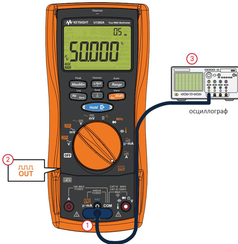
Рис. 2–36 Вывод прямоугольного сигнала
