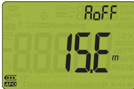
Рис. 4-3 Отображение AoFF
