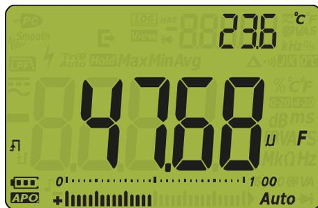
**Рис. 2–21** Отображение емкости
