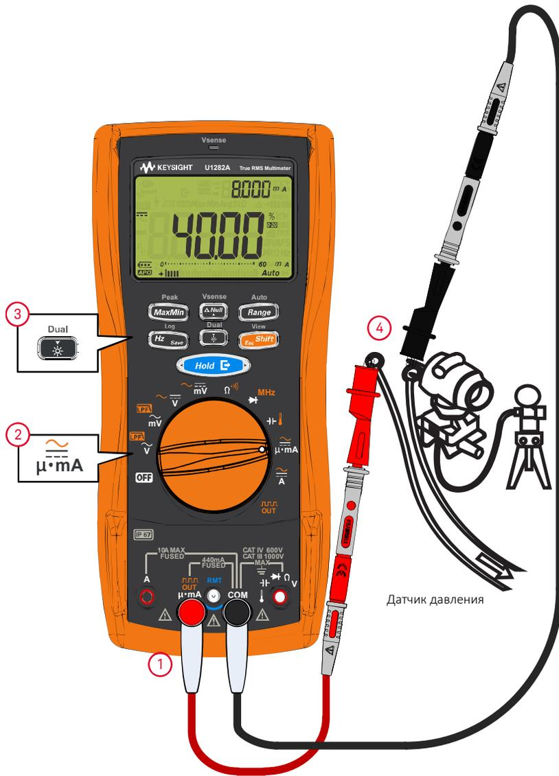
Рис. 2–30 Измерение силы постоянного тока с помощью процентной шкалы от 0 до 20 мА
