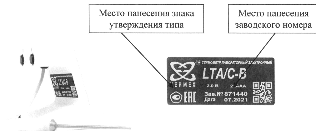
Рисунок 1 – внешний вид термометра с дискретным входом/выходом и двумя каналами измерений температуры: канал 1 — датчик с разъемным соединением, подключенный непосредственно к электронному блоку; канал 2 — датчик с разъемным соединением, подключенный к электронному блоку с помощью кабеля-удлинителя
