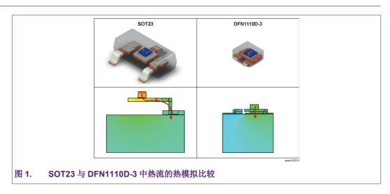
几十年来,有引脚 SMD 封装一直都是分立式电子器件的行业标准。SOT23 可能是世界上最著名的 SMD 封装,其结构如图 1 所示。图中芯片置于引脚框架上,与金属焊盘一起采用复合模具完全封装。 主要的热传输机制为热传导,因为在给定结构和温度范围内,热对流与辐射几乎无关紧要。产生的热量通过芯片贴片层传导至引脚框架中,然后从引脚框架流经长引脚进入 PCB。图 1 中的热模拟显示了 SOT23 封装器件沿引脚框架并穿过封装中间部分的横截面,突出显示了热通道。
