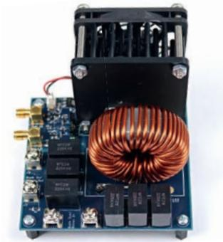
氮化镓场效应晶体管半桥电路
