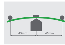
图9: 带有可湿性侧面的DFN封装的电路板稳健性提高
