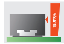
图9: 带有可湿性侧面的DFN封装的电路板稳健性提高
