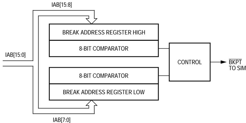
**Figure 11-1. Break Module Block Diagram**
