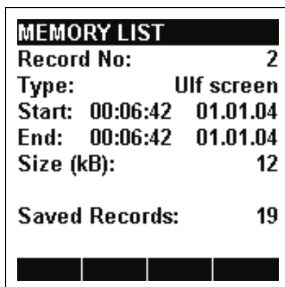
Рисунок 13.1: Вид экрана MEMORY LIST (СПИСОК ПАМЯТИ)
