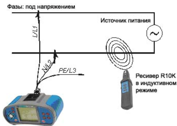
Рисунок С.3 - EurotestAT как источник сигнала для отслеживания линий
