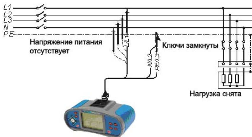
Рисунок 0.2 – Подключение измерительного кабеля для измерения сопротивления изоляции (TEST: L-PE)
