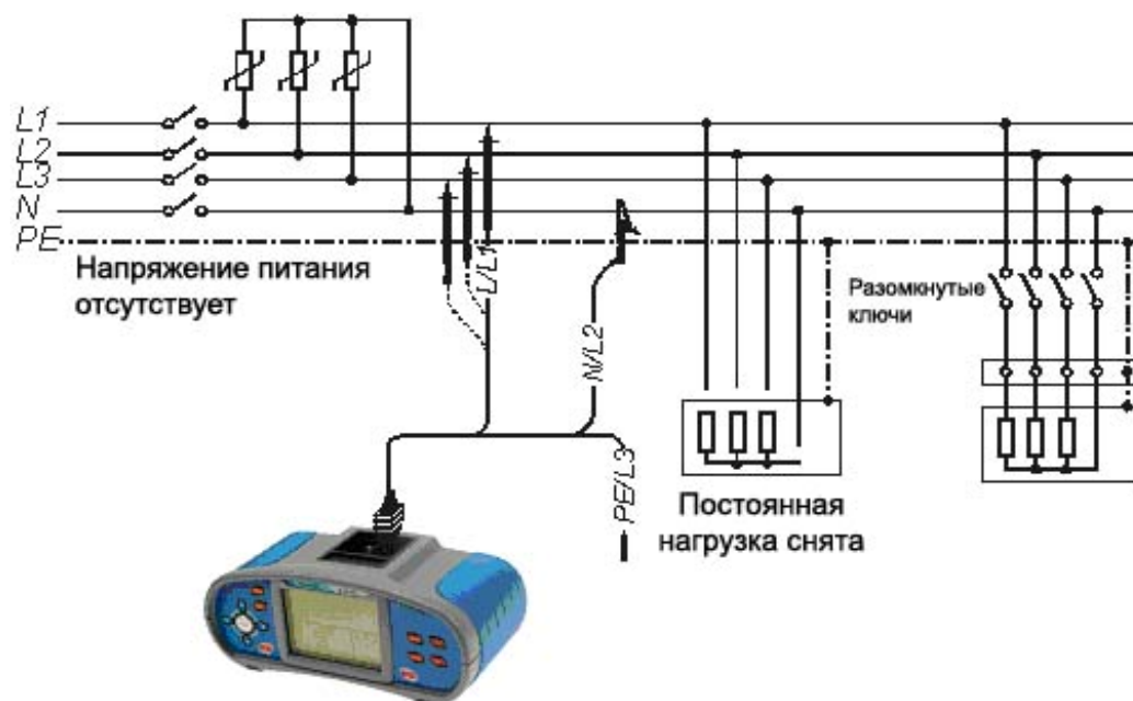
Рисунок 5.44 – Подключение трехпроводного измерительного кабеля для выполнения испытания варистора
