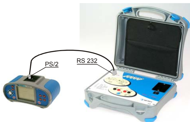
Рисунок 0.35 – Подключение адаптера полного сопротивления к прибору
