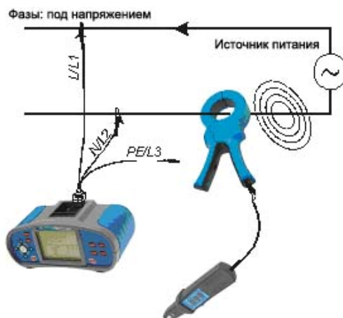
Рисунок С.4 – Передатчик как активная нагрузка, клещи используются вместо индуктивного датчика
