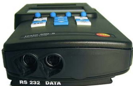
соединение с шиной данных Testo Соединение RS232
