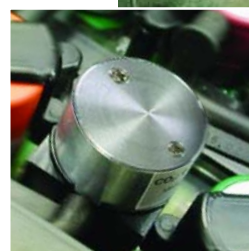
Инфракрасный (NDIR) измерительный модуль для прямого измерения CO 2
