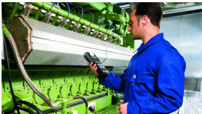
testo 350 XL: Контрольные измерения на двигателях (O 2 , CO, NO, NO 2 )
