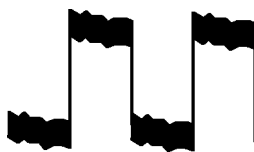
Обычное изображение сигнала в режиме пиковой детекции
