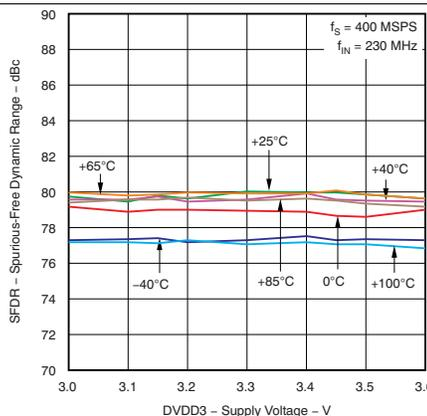
Figure 25. SFDR vs DVDD3 Over Temperature
