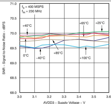
Figure 24. SNR vs AVDD3 Over Temperature
