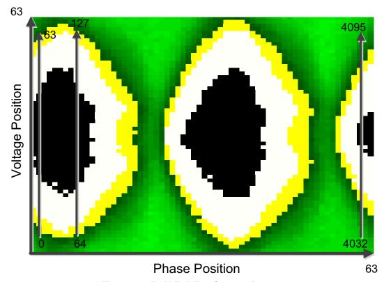
Figure 14. EOM Full Eye Capture Readout
