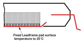
Figure 20. PowerPAD™ θ<sub>JP</sub> Measurement
