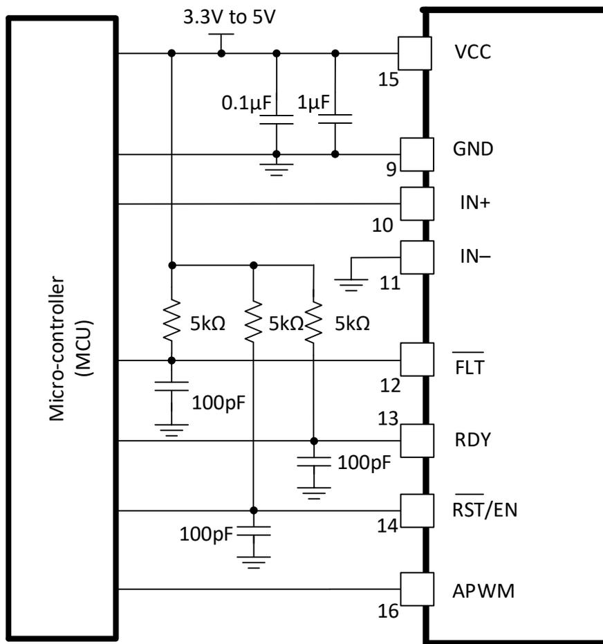
Figure 9-3.  $\overline{\text{FLT}}$ ,  $\overline{\text{RDY}}$  and  $\overline{\text{RST/EN}}$  Pins Circuitry
